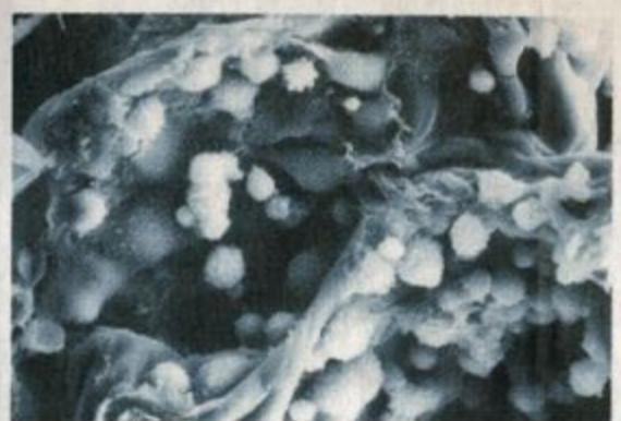
● Sponsachtige structuur van een matrijs voor tissue engineering. Het polymeer vormt zich rond zoutkristallen die in water worden opgelost, zodat een holle structuur overblijft.
